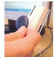
USB-RIF – Pöytälukijalla varustettu lukijarajapinta-muunnin korttien ja tunnisteen ohjelmointiin, tunnisteen nopeaan hakuun ja järjestelmään kirjautumiseen.
